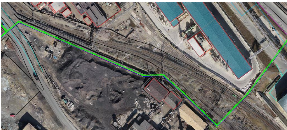
Slika 4. Paralelno vođenje kablova duž zida ograde i prelazak preko koloseka interne pruge
