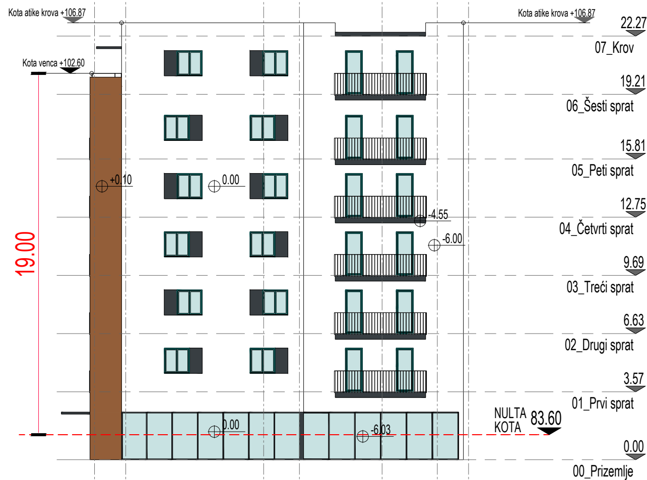
Objekat E - Izgled Severo-Istočne fasade
